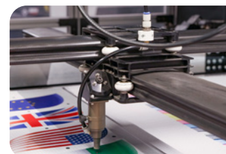
Assi X-Y in carbonio ultraleggero
